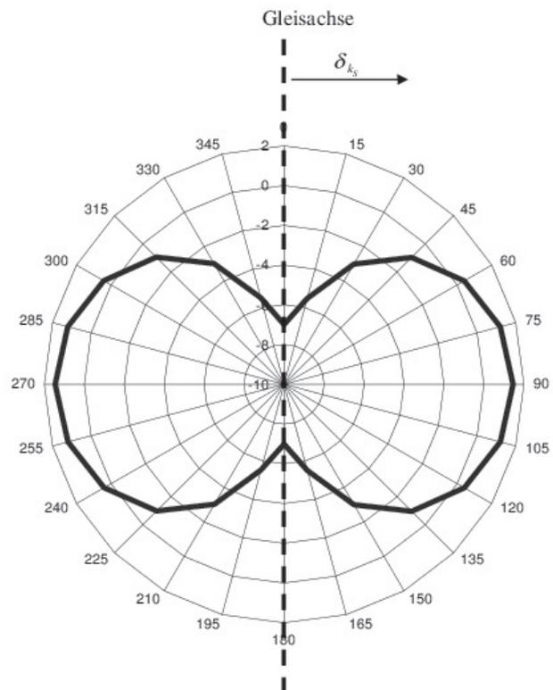
Bild 3: Richtwirkungsmaß  $D_{l,kS}$  in dB nach Gleichung (Gl. 8) für  $\delta_{kS}$  in Grad
