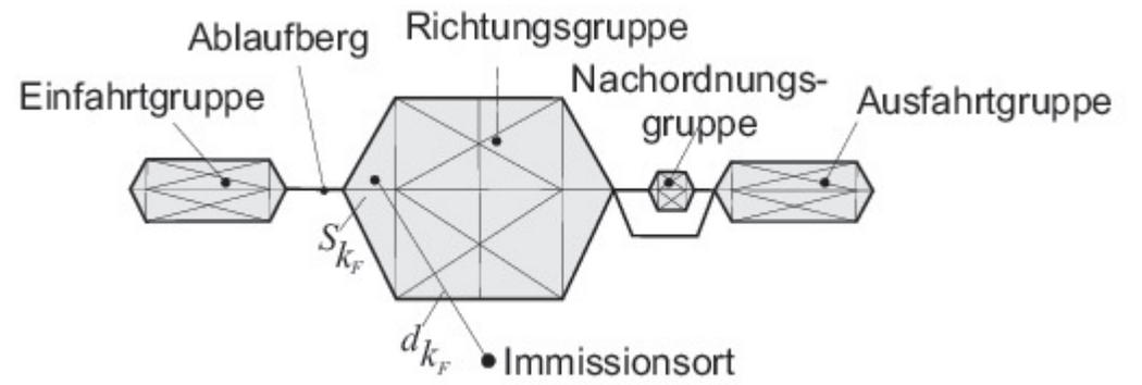
Bild 1: Beispiele für die Zerlegung von Linien- und Flächenschallquellen in Teilstücke und Teilflächen
